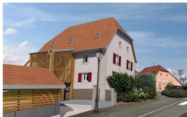
Il s'agit de créer deux cabinets médicaux au rez-de-chaussée et deux logements duplex : un T2 et un T3 au 1<sup>er</sup> étage et combles. La petite véranda et l'escalier extérieur existants sont démolis façade sud arrière. Un escalier extérieur est créé à son emplacement permettant un accès indépendant aux logements. L'entrée principale du bâtiment existante est conservée pour les cabinets médicaux.
